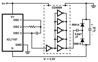
FIGURE 9. GENERATING NEGATIVE SUPPLY FROM +5V
